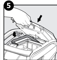
Réinsérez le panier filtrant propre et fermez le couvercle de filtre
