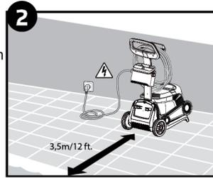
Afin d'éviter les risques d'électrocution, placez l'alimentation électrique à au moins 11 cm au dessus du sol et à une distance de 3,5 m par rapport au bord de la piscine.
