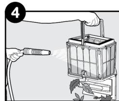
Nettoyez l'intérieur et l'extérieur du panier filtrant à l'aide d'un tuyau d'arrosage.
